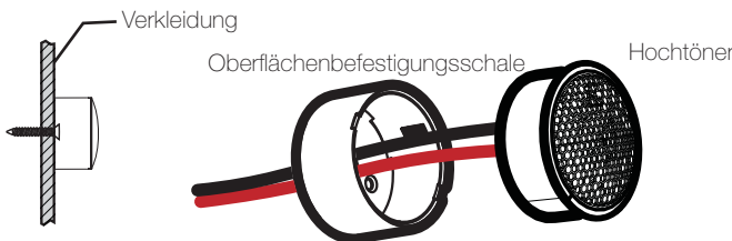
Abb. 4 Einbau auf der Oberfläche
